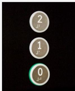
Die Standardtaster der Serie DB-02 entsprechen EN 81-70. Mit einem Tastflächendurchmesser von 44 mm, taktilen Zeichen und Symbolen von 15 mm Höhe, Brailleschrift, optischer und akustischer Rufbestätigung sowie verschiedenen Optionen für die Edelstahl-Deckplatte werden auch die neuen Anforderungen an den Leuchtdichtenkontrast erfüllt – und das mit Stil.
