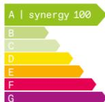
Las mediciones realizadas en una configuración de elevador estándar con el modo de espera alcanzan la calificación de eficiencia energética A, la categoría 1 y 2 más alta en uso, de acuerdo con VDI 4707. La clasificación tiene en cuenta dónde se instalará el elevador, así como el consumo de energía durante el viaje y en espera.
