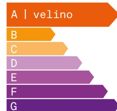
As medições realizadas em uma configuração de elevador padrão com o modo stand-by atingem a classificação de eficiência energética A, a mais alta na categoria de uso 1, de acordo com a VDI 4707. A certificação leva em consideração onde o elevador será instalado, bem como o consumo de energia durante suas viagens e no modo de espera.
