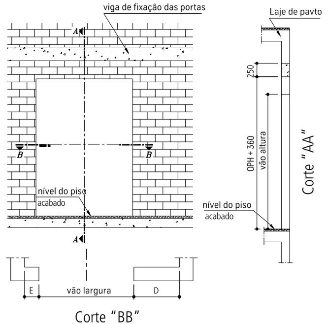
As golas devem ser acabadas e rebocadas internamente, antes do início da instalação, com exceção do pavimento de acesso. (As golas não deverão ser de concreto).
