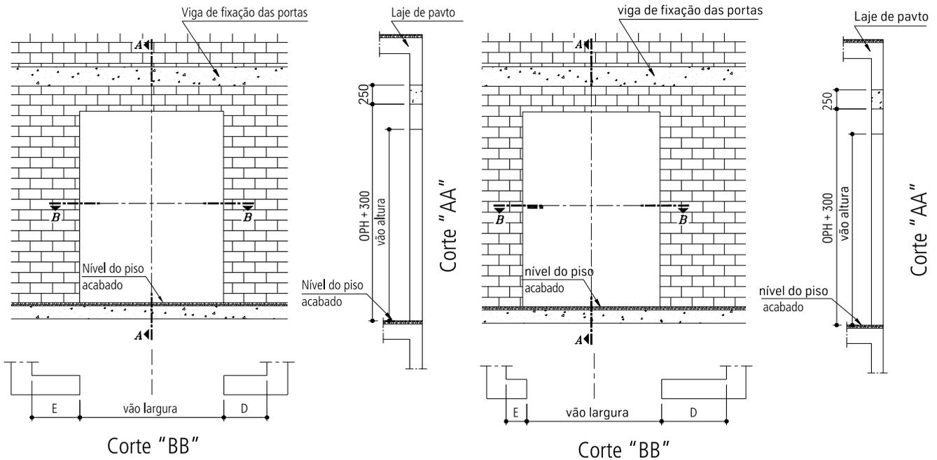
As golas devem ser acabadas e rebocadas internamente, antes do início da instalação, com exceção do pavimento de acesso. (As golas não deverão ser de concreto).
