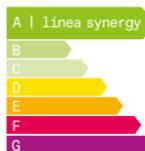
Las mediciones realizadas en una configuración de elevación estándar con modo de disponibilidad logran la calificación de eficiencia energética A, en la categoría de uso 3, según ISO 25745-2. La certificación tiene en cuenta dónde se instalará el ascensor, así como el consumo de energía durante sus viajes y en modo de espera.
