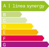
Las mediciones realizadas en una configuración de elevación estándar con modo de disponibilidad logran la calificación de eficiencia energética A, en la categoría de uso 3, según ISO 25745-2. La certificación tiene en cuenta dónde se instalará el ascensor, así como el consumo de energía durante sus viajes y en modo de espera.
