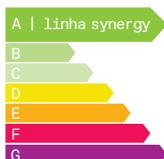
As medições realizadas em uma configuração de elevador padrão com o modo stand-by atingem a classificação de eficiência energética A, na categoria de uso 3, de acordo com a norma ISO 25745-2. A certificação leva em consideração onde o elevador será instalado, bem como o consumo de energia durante suas viagens e no modo de espera.
