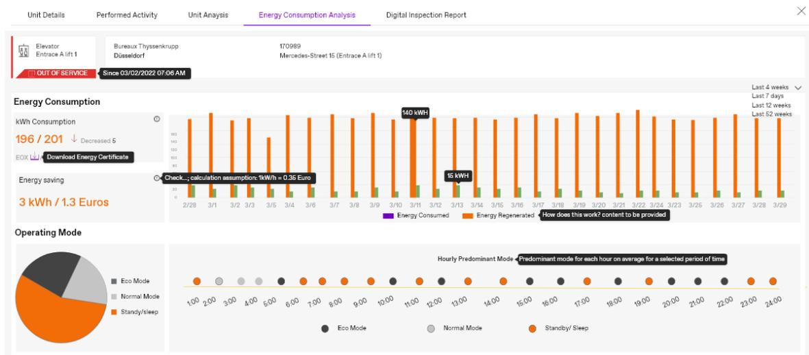
Überblick über die Energieverbrauchsanalyse eines EOX-Aufzugs über das Kundenportal von TK Elevator.
