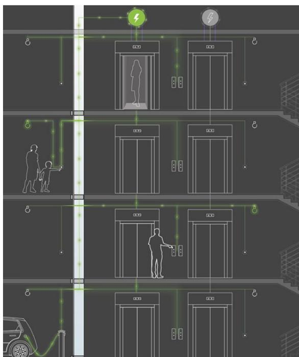
Bei EOX hingegen wird die Bremsenergie durch einen rückspeisefähigen Antrieb in elektrische Energie umgewandelt. Diese wird über die gleiche elektrische Leitung an die Stromquelle übertragen und in das Stromnetz des Gebäudes eingespeist.
