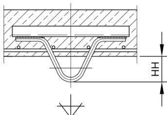
Il carico massimo simultaneo dei ganci è determinato dal metodo di installazione
