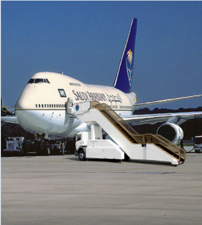
Abb.1: Die mobile Fahrtreppe dockt an die Boeing 747 an
