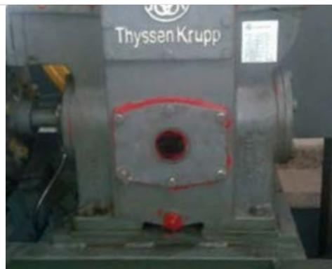
Vazamento de óleo na caixa redutora
